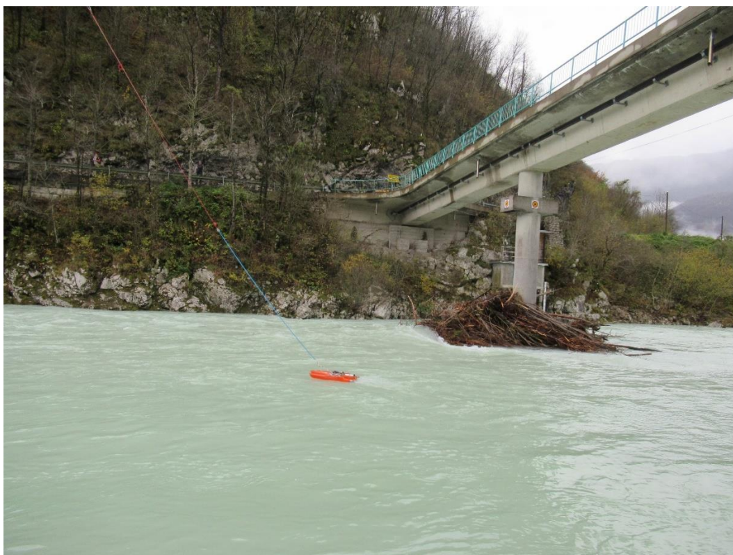
Slika 4: Meritev pretoka visoke vode Soče v Logu Čezsoškem z ADCP merilnikom s pomočjo vrvne premostitve (foto: Marko Burger)
