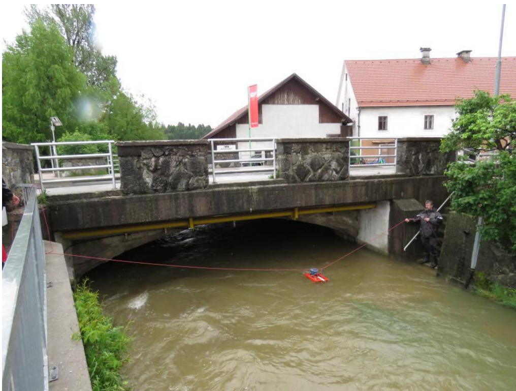
Slika 10: Meritev pretoka Logaščice v Logatcu 29. maja 2019 ob 13.30 uri (foto: arhiv ARSO)
