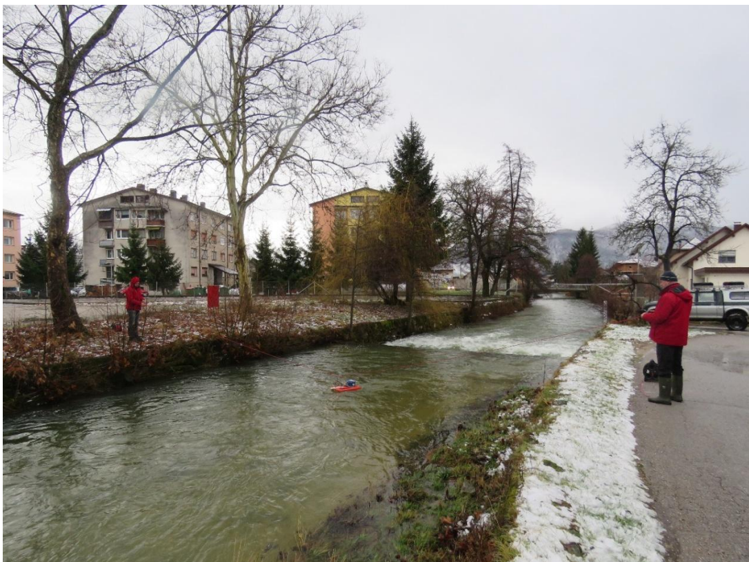
Slika 22: Meritev pretoka Cerknjščice v Cerknici 13.12.2017 (foto: arhiv ARSO)
