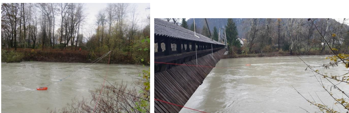
Slika 16: Meritev pretoka Save 17. novembra 2019 v Črnučah (levo) in v Mednem (desno) (foto: arhiv ARSO)
