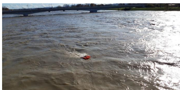
Slika 25: Meritev pretoka Drave 18. novembra 2019 v Borlu (levo) in na Ptuju (desno) (foto: arhiv ARSO)
