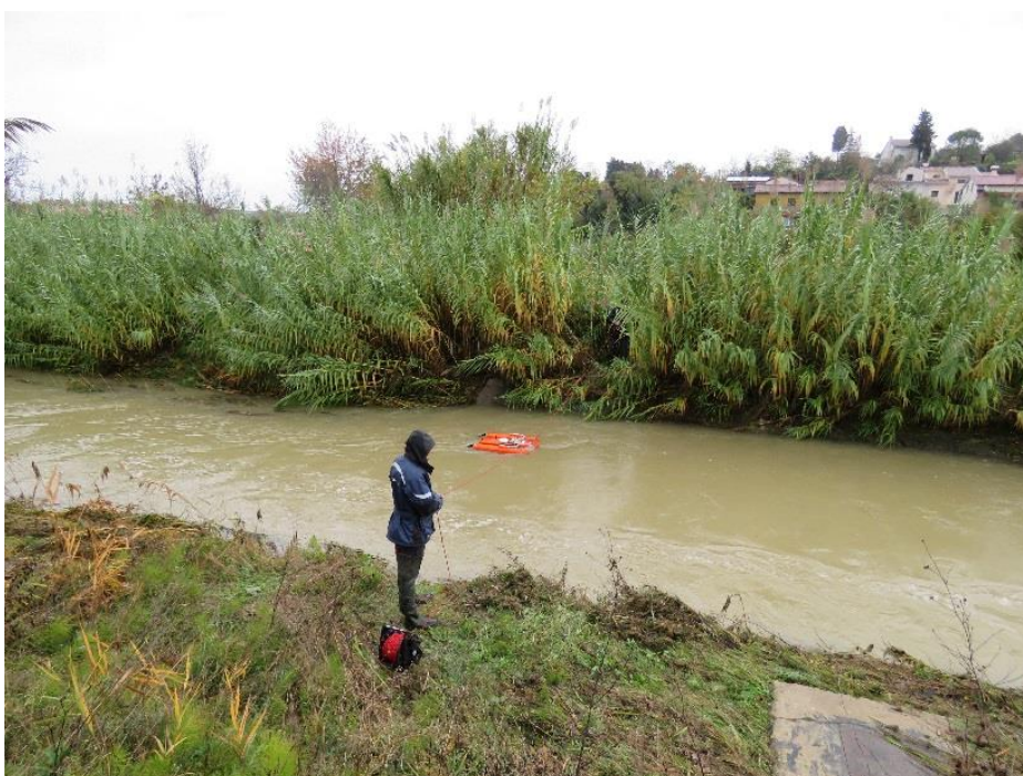
Slika 14: Meritev pretoka Badaševice v Šalari 13. novembra 2019 (foto: arhiv ARSO)
