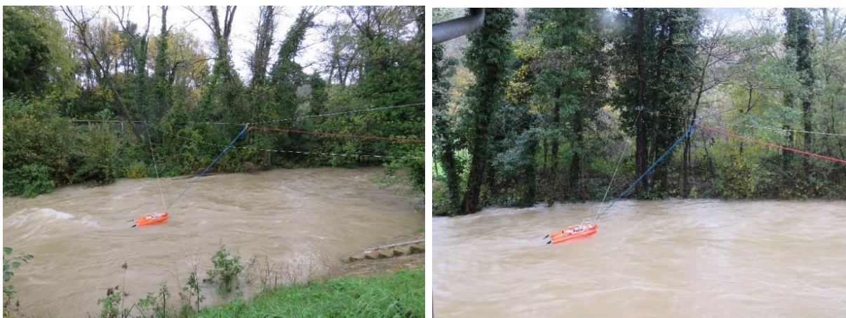
Slika 15: Meritev pretoka Rižane 13. novembra 2019 v Dekanih (levo) in v Kubedu (desno) (foto: arhiv ARSO)
