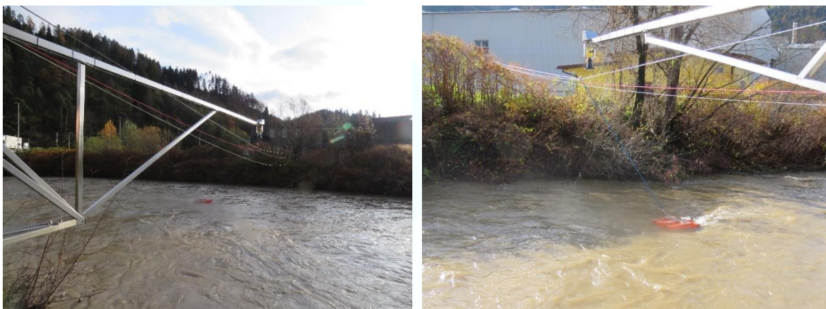
Slika 23: Meritev pretoka Meže v Otiškem Vrhu 18. novembra 2019 (levo) in Mislinje v Otiškem Vrhu (desno) (foto: arhiv ARSO)
