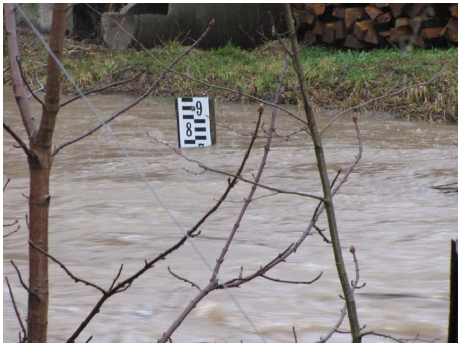
Slika 18: Vodomerne postaja Gradaščica Dvor dne 30. 3. 2009 ob 10. uri pri pretoku 42 \text{ m}^3/\text{s} . Pri takem pretoku pride do razlivanja vode po okoliških travnikih v neposredni bližini postaje (foto: Mojca Robič).
