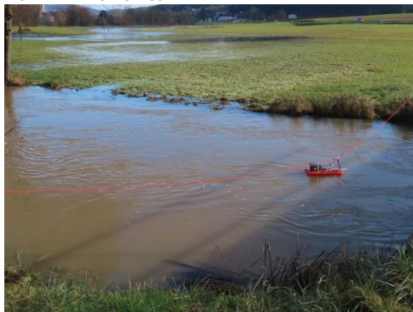
Slika 1. Hidrometrične meritve na Mirni na vodomerni postaji Jelovec (levo) in Temenici na vodomerni postaji Rožni vrh (desno), opravljene 14. decembra 2023.
