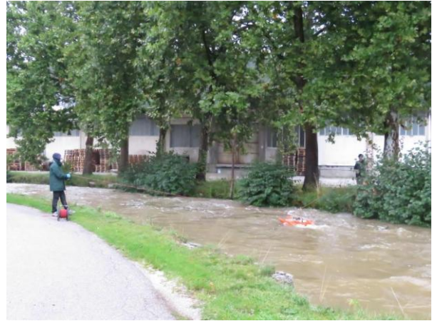
Meritev pretoka Save v Šentjakobu 15.9.2017 (slika levo) in Cerknjščice v Cerknici 16.9.2017 (slika desno) (foto: arhiv ARSO)
