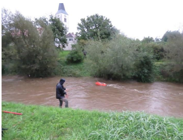
Meritev pretoka Drave v Dravogradu (slika levo) in Dravinje v Ločah (slika desno) 19.9.2017 (foto: arhiv ARSO)
