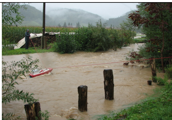
Slika 12: Uspešno izvedena meritev z ADMP s frekvenco 600 kHz na v.p. Dvor – Gradaščica (foto: M. Burger)
