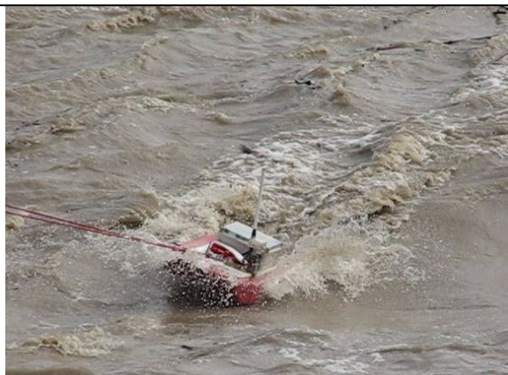
Slika 10: Hiter in valovit tok vpliva na gibanje čolnička in kvaliteto meritve (foto: M. Burger)
