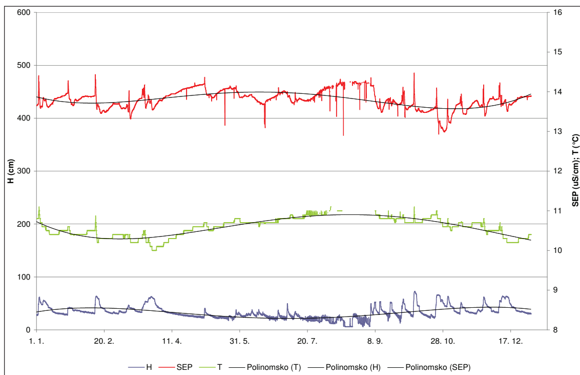
Slika 6: Časovni potek vodostajev (H), specifične električne prevodnosti (SEP) in temperature (T) na izviru Metliški Obrh. Figure 6: The timeline of water levels (H), specific electrical conductance (SEP) and temperature (T) on the Metliški Obrh spring.
