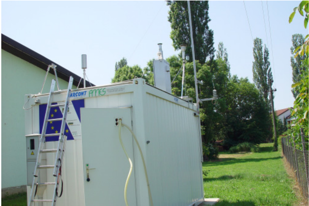
Slika 1. Izvedba primerjalnih meritev delcev med Leckel in TEOM merilnikom na merilnem mestu Murska Sobota. Figure 1. Comparison measurements between Leckel and TEOM instrument on monitoring station Murska Sobota.
