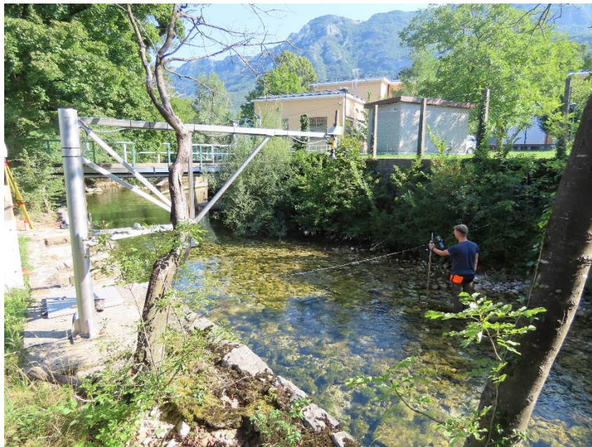
Slika 2. Izvajanje meritve pretoka na območju izvira Hubelja v Ajdovščini, začetek jeseni 2021 (foto: arhiv ARSO) Figure 2. Discharge measurement at Hubelj spring at the beginning of the autumn 2021 (photo: ARSO archive)
