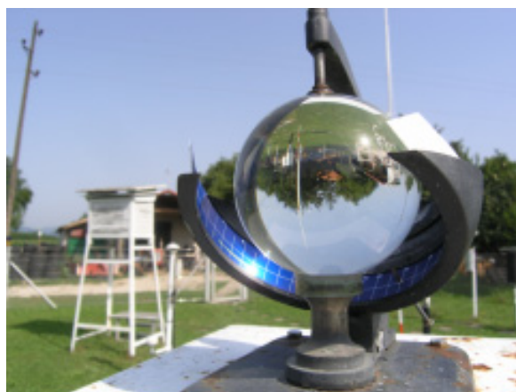
Slika 12. Meteorološka postaja Šmartno pri Slovenj Gradcu in heliograf na tej postaji (foto: Iztok Sinjur) Figure 12. Meteorological station Šmartno pri Slovenj Gradcu and heliograph (Photo: Iztok Sinjur)
