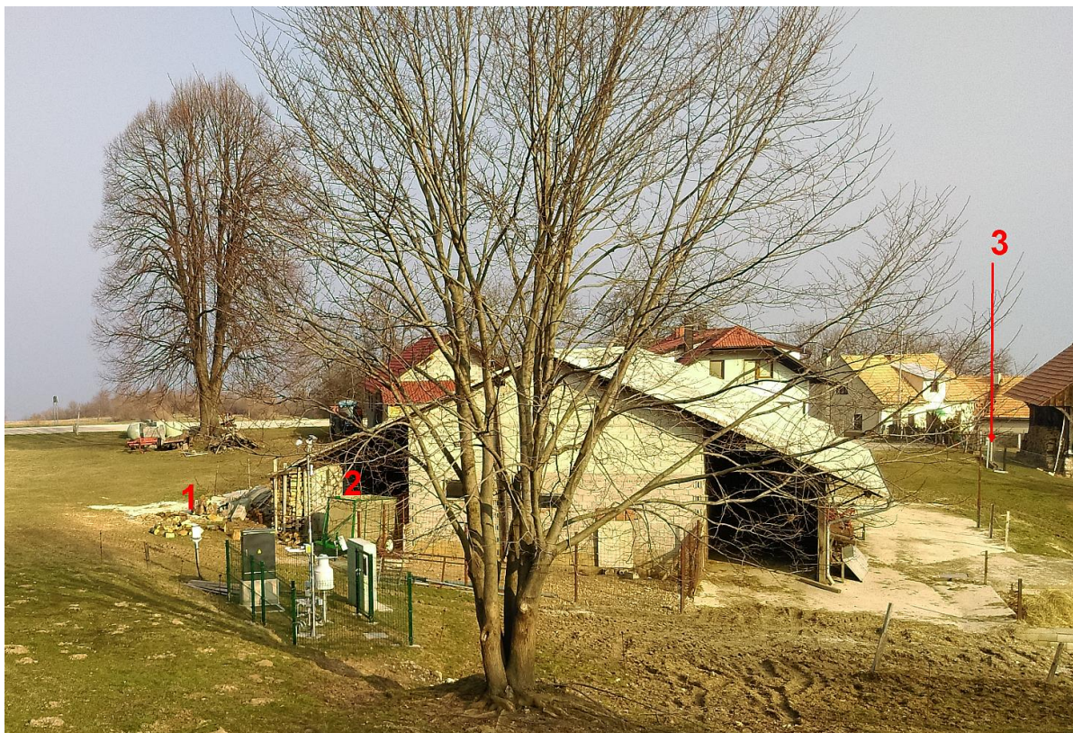
Slika 2. Samodejna in padavinska postaja ter elektronski zapisovalnik na Planini v Podbočju, marec 2017 (arhiv ARSO). S številko 1 je označen elektronski zapisovalnik, z 2 samodejna postaja in s 3 dežemer. Figure 2. Data logger (1) and automatic meteorological (2) and precipitation station (3) in Planina v Podbočju, photo was taken in March 2017
