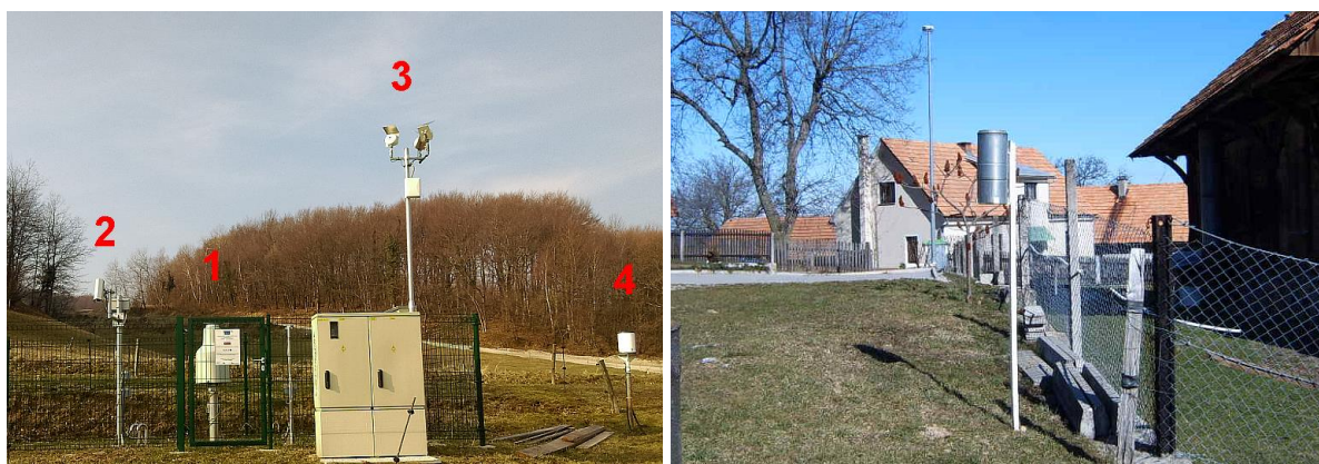
Slika 3. Samodejna postaja in elektronski zapisovalnik, marec 2017 (levo) in padavinska postaja, dežemer ali pluviometer, na Planini v Podbočju, marec 2009 (arhiv ARSO). Na levi sliki je s 1 označen tehtalni ombrometer, z 2 senzor za lasersko merjenje snežne odeje, s 3 kamere za trenutno vreme in s 4 elektronski zapisovalnik padavin. Figure 3. Automatic meteorological station and data logger in March 2017 (left photo) and precipitation station in March 2009 in Planina v Podbočju (archive ARSO)
