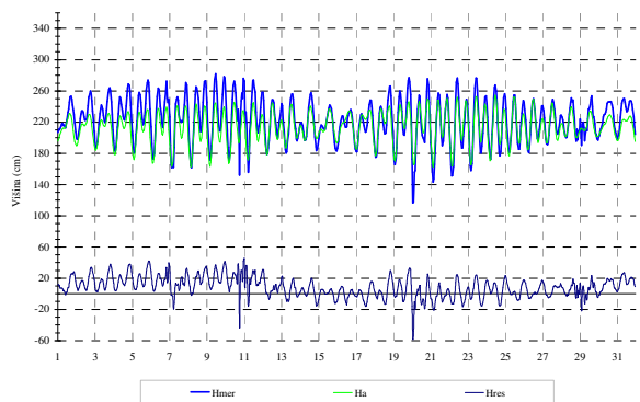
Slika 3. Izmerjene urne (Hmer), astronomske (Ha) in residualne (Hres) višine morja v avgustu 2017. Srednja letna višina morja v dolgoletnem obdobju je 217 cm. Figure 3. Measured (Hmer), astronomic (Ha) and residual (Hres) sea levels in August 2017
